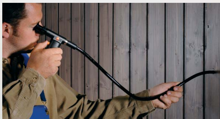
Kontrola izolace využitím směrově stabilní tuhé decarbonové trubice.
