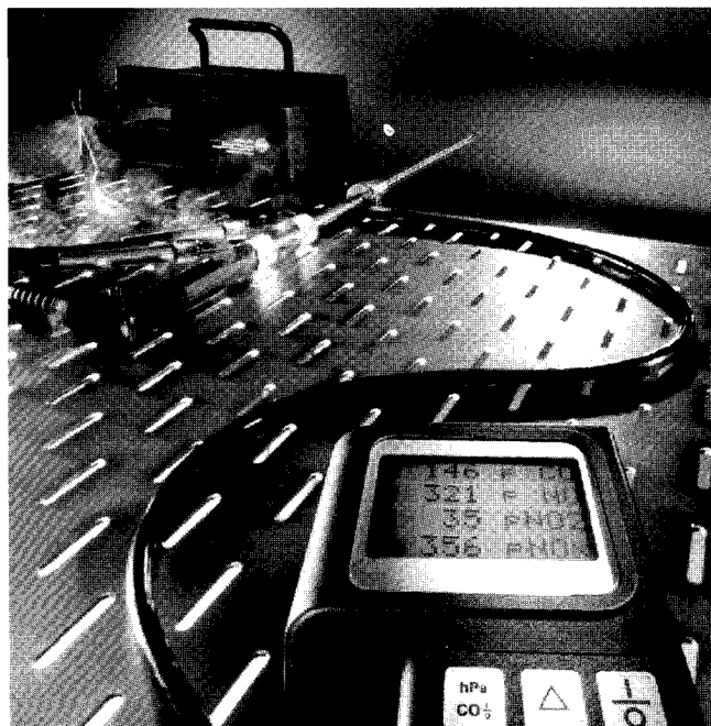
Obr.3 Analyzátor spalín testo 350
